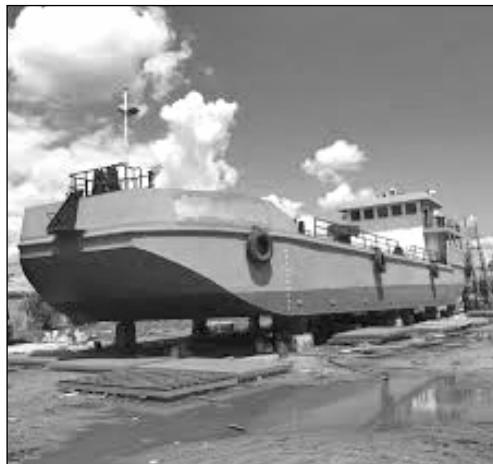
لندینگرافت شناور کوچکی است (در مقایسه با کشتی) که کف آن بر عکس کشتی‌ها (که به صورت مثلثی و غیر مسطح ساخته شده)، مسطح بوده و به همین لحاظ قادر است با استفاده از پدیده مد دریا در سواحل فاقد اسکله پیش رفته و با موقع جذر به زمین بنشیند و تخلیه یا بارگیری فرورده را با موتور پمپ‌های تعییه شده در خود انجام دهد.
