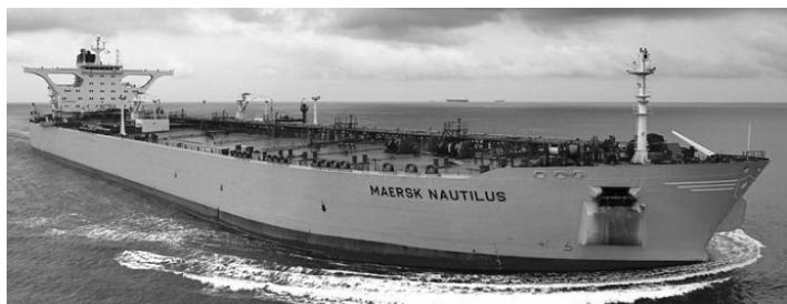
بطور کلی سطح عرضه این کشتی‌ها از لوله‌های ارتباطی مخازن کشتی و پمپ‌های مربوطه پوشیده شده است که مخصوص عملیات بارگیری، تخلیه نفت خام و بعضی فرآوردهای نفتی هستند.
