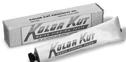
برای تعیین وجود یا عدم وجود آب در ته مخازن مقدار کمی از این خمیر را به قسمت مدرج شده زیرین میله یا نوار اندازه‌گیری ارتفاع محتویات مخزن می‌مالند. با تغییر یافتن رنگ خمیر، تا نقطه مدرج وسیله اندازه‌گیری ارتفاع فرآورده، وجود یا عدم وجود آب در مخزن معلوم خواهد گردید.
