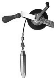
جهت مخازن نگهداری انواع سوخت که دارای ارتفاع زیاد می‌باشد از متراها یا همان نوارهای عمق یاب استفاده می‌گردد. با متراهای عمق یاب می‌توان با استفاده از خمیرآب یاب نسبت به کشف و اندازه‌گیری ارتفاع آب در کف مخازن سوخت اقدام نمود. این متراها با متراژهای ۱۰ الی ۵۰ متری با شاقول‌های ۴۰۰ یا ۶۷۵ یا ۱۶۰۰ گرمی قابل انتخاب می‌باشند.
