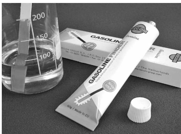
وجود آب در انواع فرآورده‌های نفتی بواسطه ماهیت جذب آب توسط بعضی ترکیبات نفتی همچنین مواردی چون تفس مخازن (دم) درهواهی مرتبط و همچنین نفوذ باران و نزولات آسمانی از سقف و اتصالات مخازن و حتی نشتی آب گرم شونده فرآیندی در پالایشگاه ازمبدل‌های خنک کننده محصول به فرآورده خنک شونده ارسالی به مخازن محصول و بسیاری عوامل دیگر سبب می‌گردد فرآورده‌های نفتی همواره دارای مقادیری آب باشند که دراثر سکون مخزن و سقوط تعلیقات مائی، بصورت آب آلوده به ترکیبات سبک و آروماتیک نفتی درکف مخزن ته نشین شوند.
