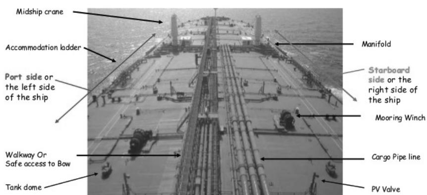
همانگونه که در تصویر فوق مشاهده می‌گردد، راهروهایی (Walk Way) نیز جهت دسترسی اینم به سیستم‌های عملیاتی مانند لوله‌ها و تجهیزات کنترل تخلیه و بارگیری نفتکش نیز تعبیه شده است. همچنین مخازن این نفتکش مجهز به شیرهای کنترل فشار بوده و از حیث فنی و عملیاتی، اهم عملیات نگهداری فرآورده‌های نفتی در مخازن ثابت زمینی را درخصوص این نفتکش‌ها اعمال می‌نمایند.
