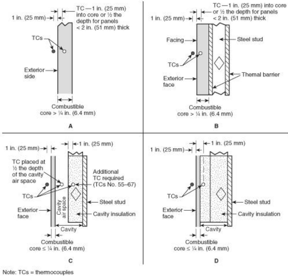
**FIGURE 6.1(b) Instrumentation Arrangement.**
